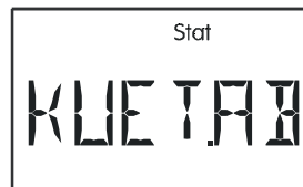
Kollektor – Über- temperatur – Ab- schaltung ist aktiv
